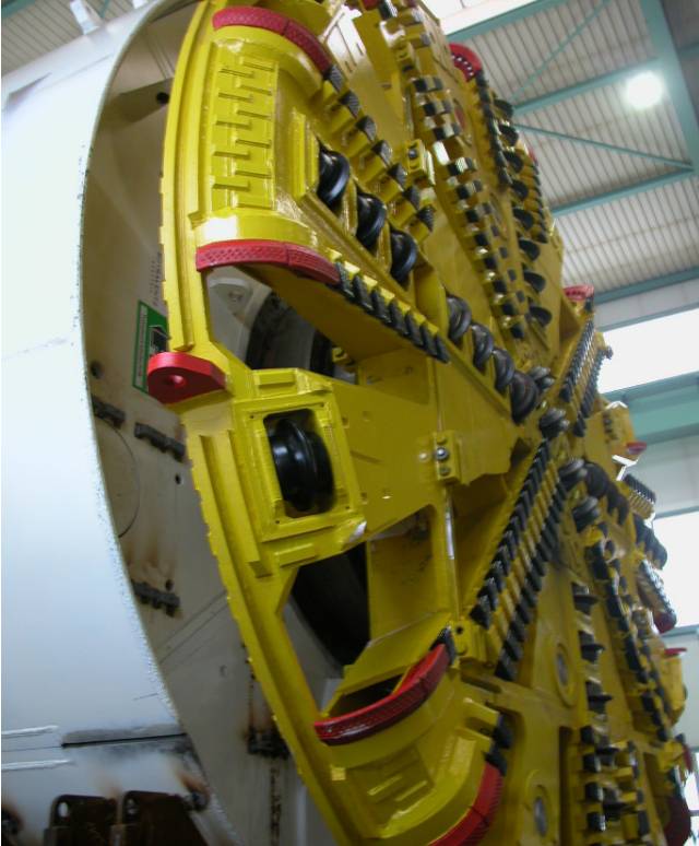
Das Schneidrad mit 176 Schälmessern, 16 Räumern, 36 einfachen und 6 doppelten Schneidrollen
